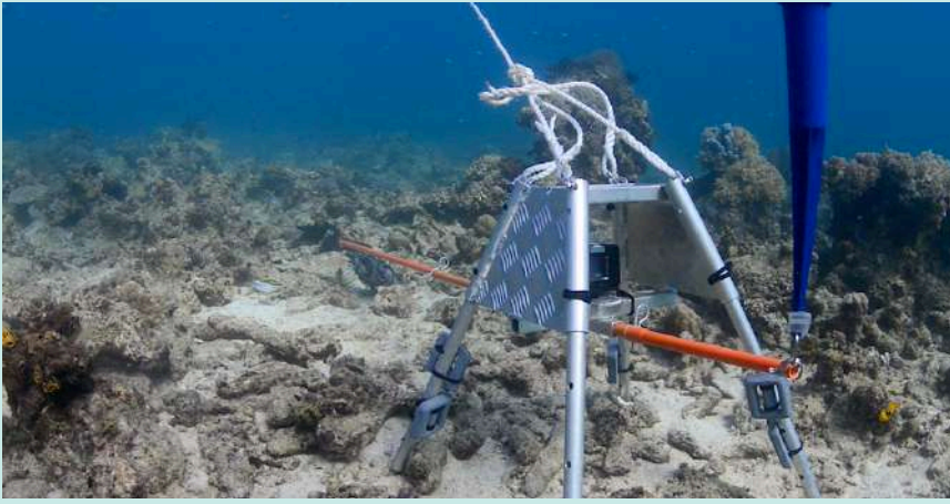
Gambar 3: Sebuah BRUVS menggunakan rangka stainless steel dan kaki yang dapat dilepas, dan pemberat yang diikat dengan kabel di lokasi. Kaki-kaki BRUVS dilubangi agar tinggi bingkai dapat diatur. Pengukur arus dipasang di bagian belakang ujung tiang umpan. (Sumber: Christian Sloater, Scubazoo)
