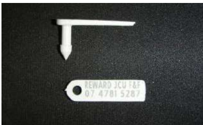
Gambar 2: Bagian rototag jantan (atas) dan betina (bawah). (Sumber: Michelle Heupel)
