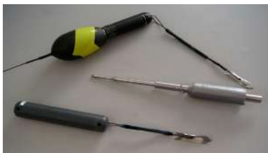
Gambar 11: Penanda PSAT dengan dart tag dan jarum pemasang untuk tongkat. (Sumber: Juerg Brunnschweiler)
