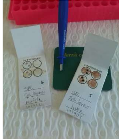
Gambar 1: Jaringan hiu pada dua lingkaran Kartu FTA Elute dan dua bolongan diambil dari setiap lingkaran (Sumber: Sharon Appleyard, CSIRO)
