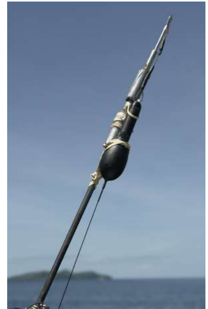
Gambar 13: Tag PSAT beserta dart tag yang dipasang pada tongkat penanda. (Sumber: Juerg Brunnschweiler)
